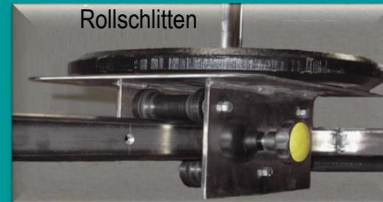
Die einzige Änderung von Vers.1 zu Vers.2 ist der Ersatz der Scheibenaufleger durch den Rollschlitten, der durch fixierbare Verschiebung sehr schnell das Lastmoment u. somit die zu bewältigende Last ändert. Dadurch ist ein schneller Probandenwechsel möglich.
